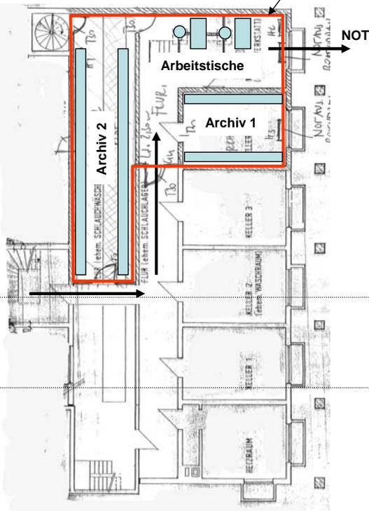
Das Untergeschoss wird über das derzeitige Treppenhaus erschlossen. Es besteht aus der ehemaligen Schlauchwäscher (Archiv 1) und zwei weiteren Räumen und einem Flur. Als WC stehen die geplanten Anlagen zur Verfügung
